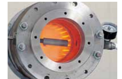
高温炉の内部観察窓（熱反射膜付）
